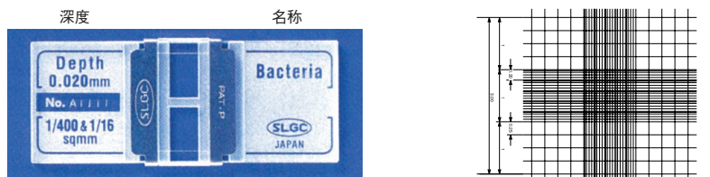
最小目盛 複式チャンバー 0.020 mm deep・1/400 & 1/16 sq mm
