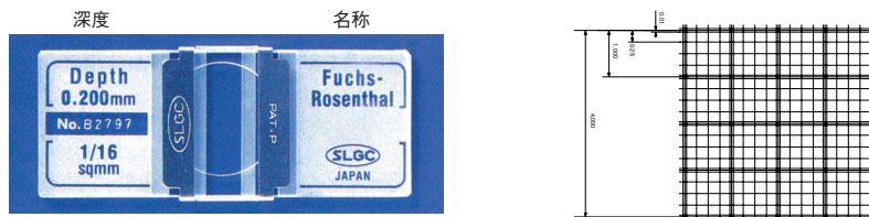
最小目盛 単式チャンバー 0.200 mm deep・1/16sq mm
